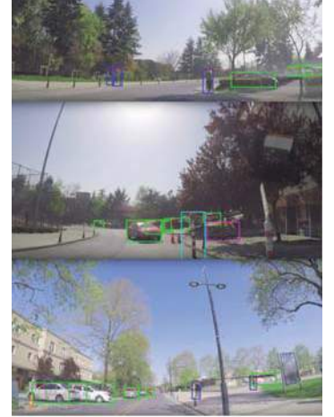
Otonom araçlar için evrimsel sinir ağı ile araç içi kameradan araba, yaya vb trafik nesnelere tespiti (Girdi Resim Kaynak: ImageNet)
