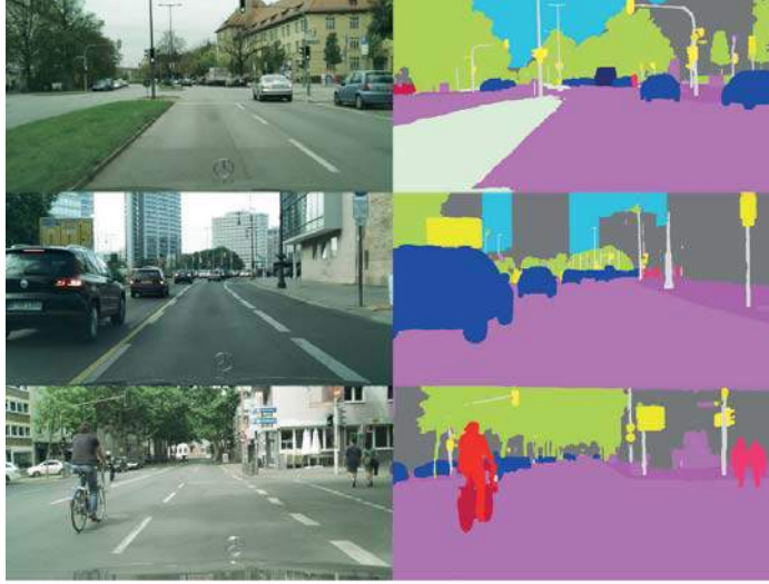
Şehir ve yol görüntülerinin otokodlayıcı derin sinir ağı ile segmentasyonu (Girdi Resim Kaynak: Cityscapes)
