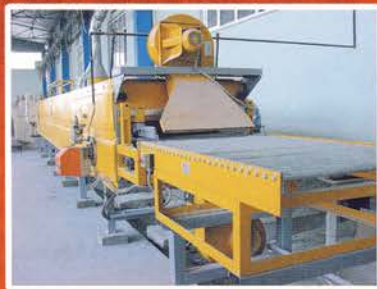
FIRINLI ÇATLAK TAMİR HATTI
